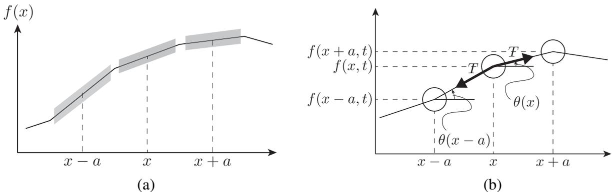
図2: (a) 弦を幅  $a$  に離散化します。(b) 離散化した各部分を重りと考え、そこに働く張力による運動方程式をたてます。
