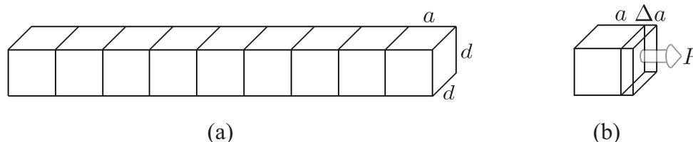
図1: (a) 単面積  $d^2$  の金属棒を長さ  $a$  の単位胞に分割します。(b) 断面に圧力  $P = F/d^2$  がかったとき、単位胞が  $\Delta a$  だけのびるとします。
